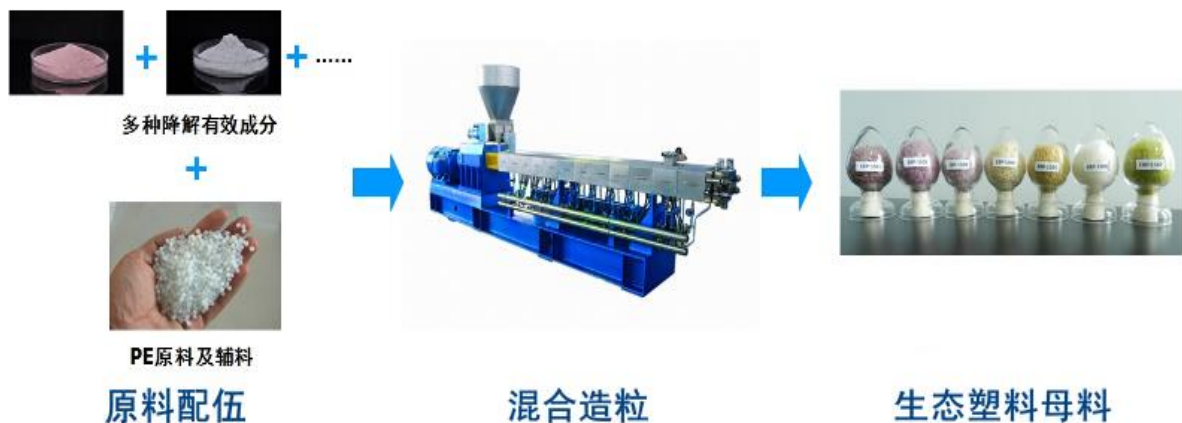
图1 纳米高分子复合型生态塑料母料制备流程
