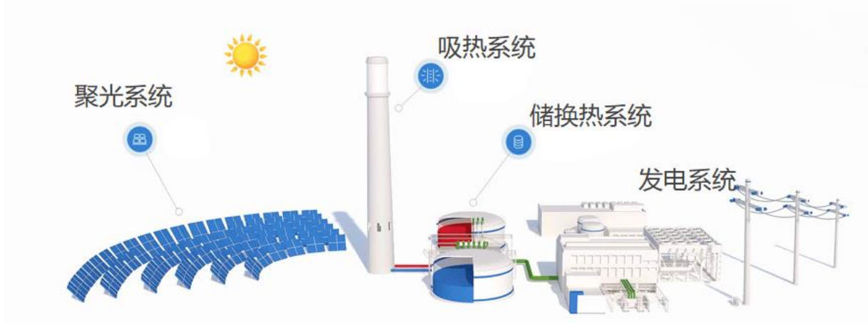
图 1 塔式太阳能热发电流程图
