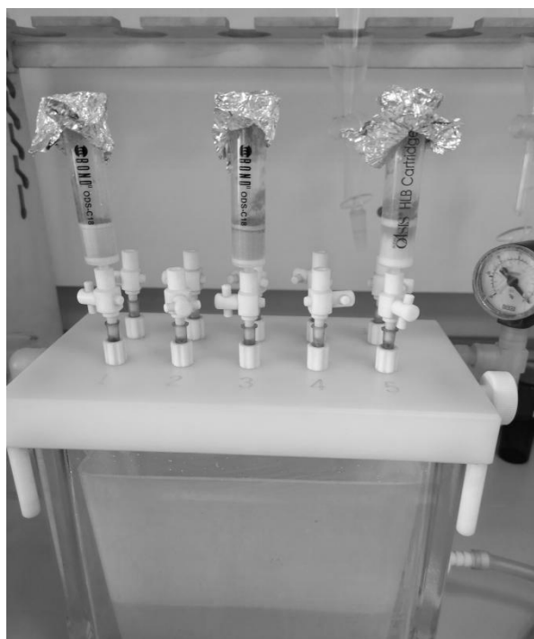
图 A: 1000 mg 的 Agilent C 18 和 Oasis HLB 柱富集样品
