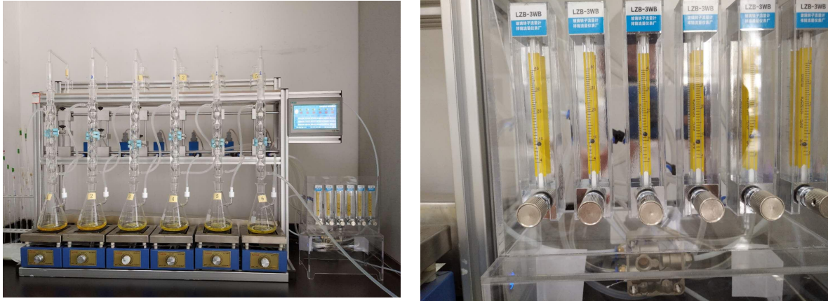
图 5.7.1-5 自组装六联共加热回流消解吸收装置
