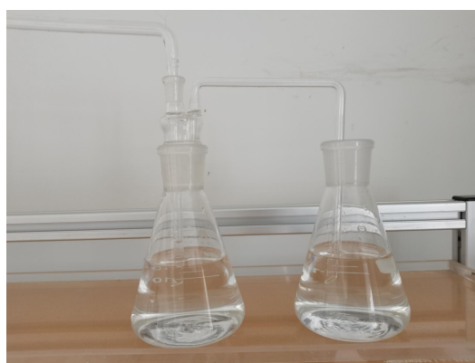
图 5.7.1-2 二次吸收装置
